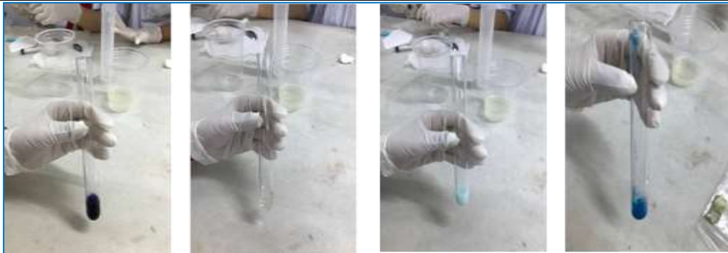
រូប 3. 2 លទ្ធផលពិសោធន៍អំពីបង្ហាញអត្តសញ្ញាណអាល់ប៊ុយមីនក្នុងស៊ុត
